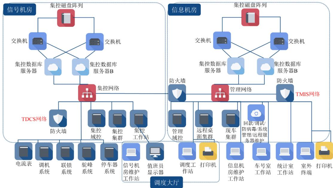
(6) 铁路电务智能运行维护管理系统：铁路综合电务智能运行维护管理系统针对铁路快速发展带来的信号设备运营维护需求，在信号监测技术的基础上，融合了大数据、物联网、GIS 地图、光通信、移动计算等成熟技术，构建了信息化、网络化、智能化的运行维护管理平台。该系统可提供运行状态监督、风险预警、故障报警以及维修应急指挥管理等功能，应用于铁路和城市轨道交通等领域。
