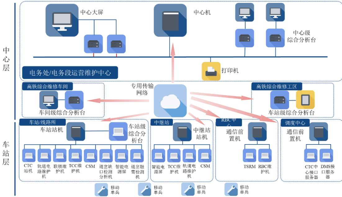
(7) 综合运输调度指挥系统：综合运输调度指挥系统统筹建设铁路运输全专业调度系统，具有全专业计划编制、安全源头管控、运输资源精准调配、行车计划自动调整等功能，能够应用于铁路各级运输生产部门，为各岗位调度人员提供统一的工作平台，目前已成功应用于海外首条全中国标准的蒙内铁路。
