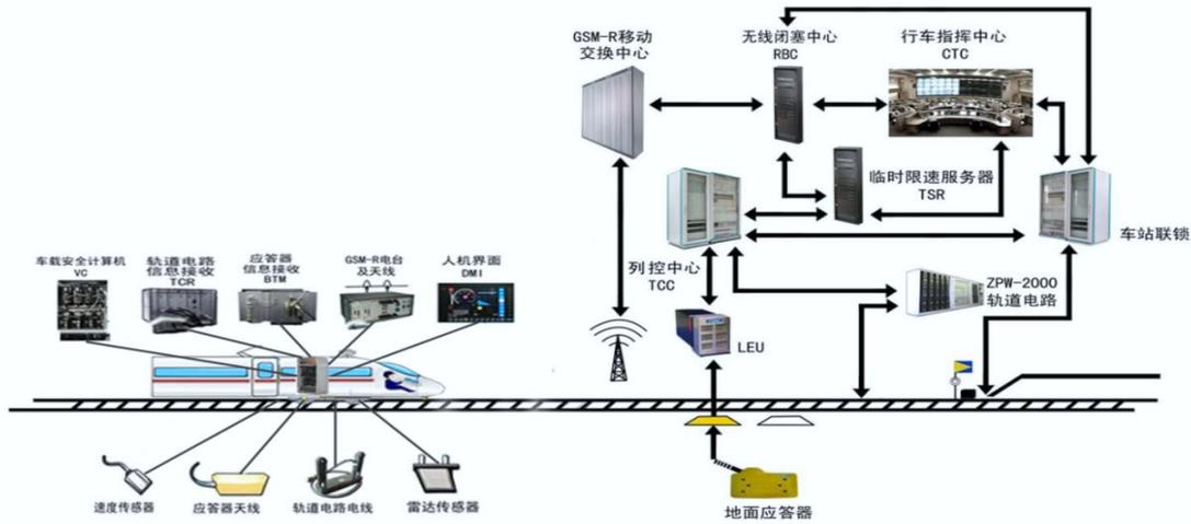
(2) 城际铁路自动驾驶列控系统 (CTCS-2+ATO): CTCS-2+ATO 适用于时速 160 公里以上的城际铁路, 满足城市间高速度、高密度、公交化运营需求, 在国际上首次实现城际铁路自动驾驶, 大幅提高了运营效率, 已在广东莞惠城际铁路投入使用。
