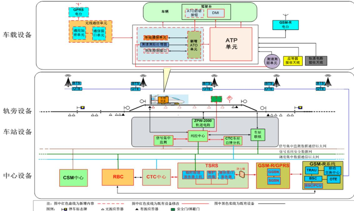
(4) 城市轨道交通列控系统（CBTC）：CBTC 系统成功装备于北京地铁 8 号线，创新实现中国城市轨道交通的互联互通，支持不同车载设备列车的跨线运行，先后在重庆、西安、长春、合肥等城市实施。CBTC 系统可以实现城市轨道交通列车安全防护、自动驾驶，可以满足城市轨道交通行车密度高、客运量大、安全、自动化程度要求高的迫切需求。
