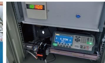
电缆成端接地冗余监测系统
