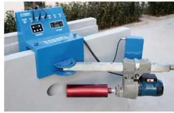
隧道电缆槽侧壁钻孔机
