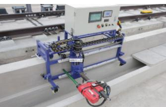
桥梁地段防撞墙钻孔机
