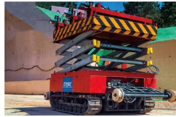
隧道漏缆施工装备
