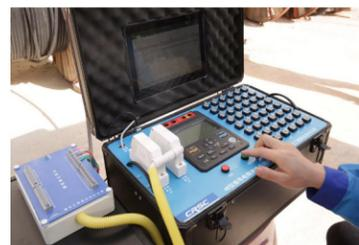
信号电缆绝缘自动测试装置
