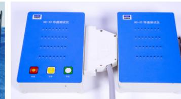
32位航空插头及电缆导通测试仪
